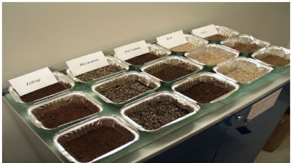
Kuva 9. Kuivumisaikakokeen (pölynsidonta) koejärjestely.
