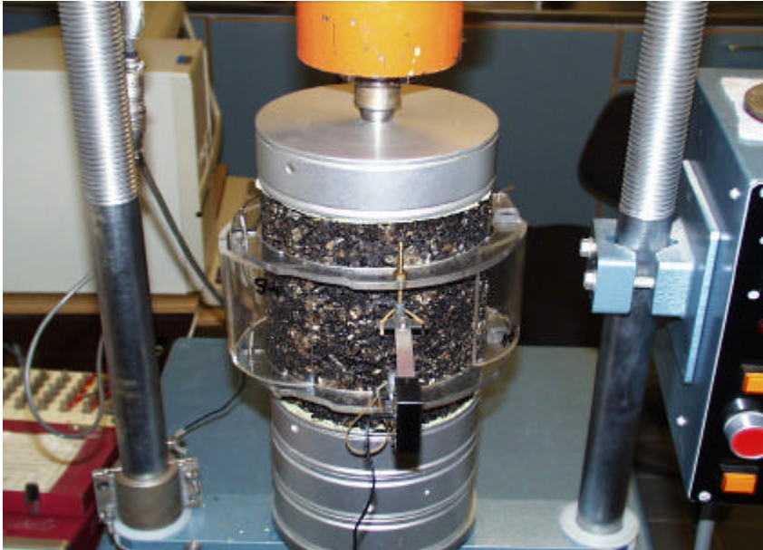
Kuva 5. Puristuslujuuskokeen koemenettely vertailunäytteellä.
