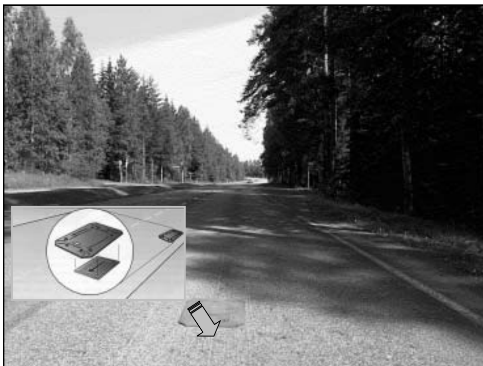
Kuva 3-1. HI-STAR - liikennelaskentalaitte asennettuna tienpintaan Hankasal- mella pisteessä 3 (mittaussuunta keskustaan päin). /4.
