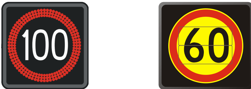
Kuva 1. Muuttuvissa nopeusrajoituksissa käytetyt merkkityypit: kuituoptyinen tai LED-merkki vasemmalla, sähkömekaaninen merkki oikealla.
