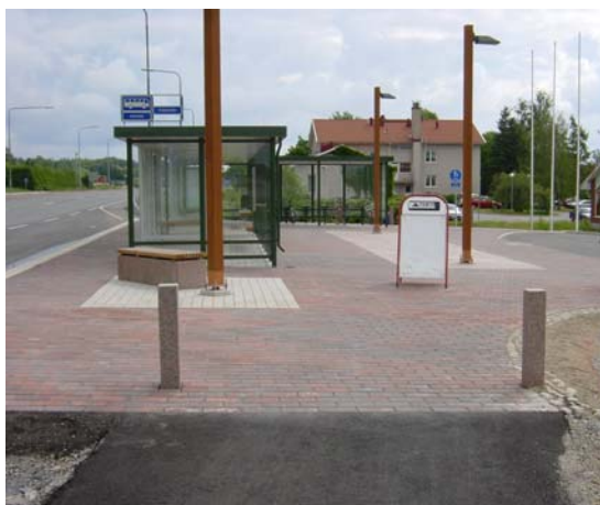
Kuva 6. Kulkuväylällä olevat kadunkalusteet hankaloittavat näkövammaisten kulkua. Etualan matalia pylviä ei ole merkitty ohjaavalla päällysteellä kuten valaisinpylviä ja mainosteline on sijoitettu kulkuväylälle.
