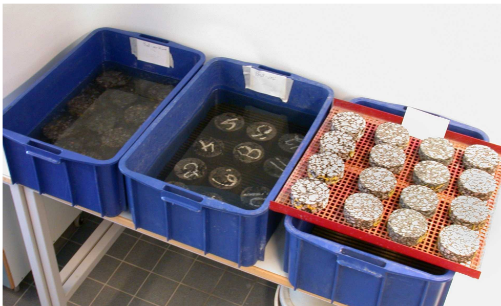
Kuva 12. Asfalttinäytteiden varastointi laboratorioissa kaliumformiaattiliuoksessa ja kuivana.
