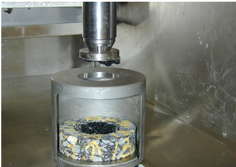
Kuva 2. Formiaatin vaikutuksen tutkiminen asfalttiporakappaleesta vetojännityskokeella VTT:ssä /8/.
