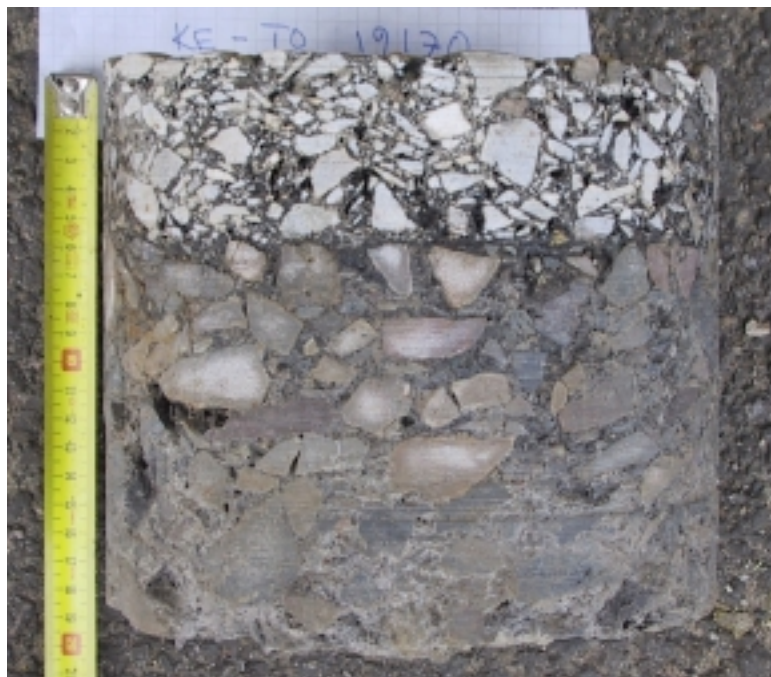
Kuva 25. Ehjä poranäyte paalulta 19170 suunnalta Kemi - Tornio. Näyte on otettu kuvan 23 ja 24 näytekohdan vierestä.
