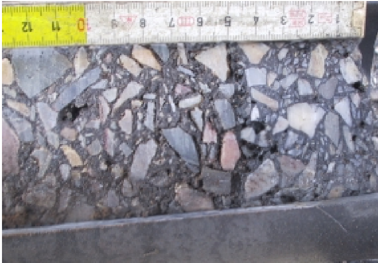
Kuva 35. Poranäyte paalulta 15 768. Välillä 45 – 80 mm voidaan nähdä sideaineen alkavaa irtoamista kivirakeista. Näytteen vesipitoisuus oli 4,1 %.
