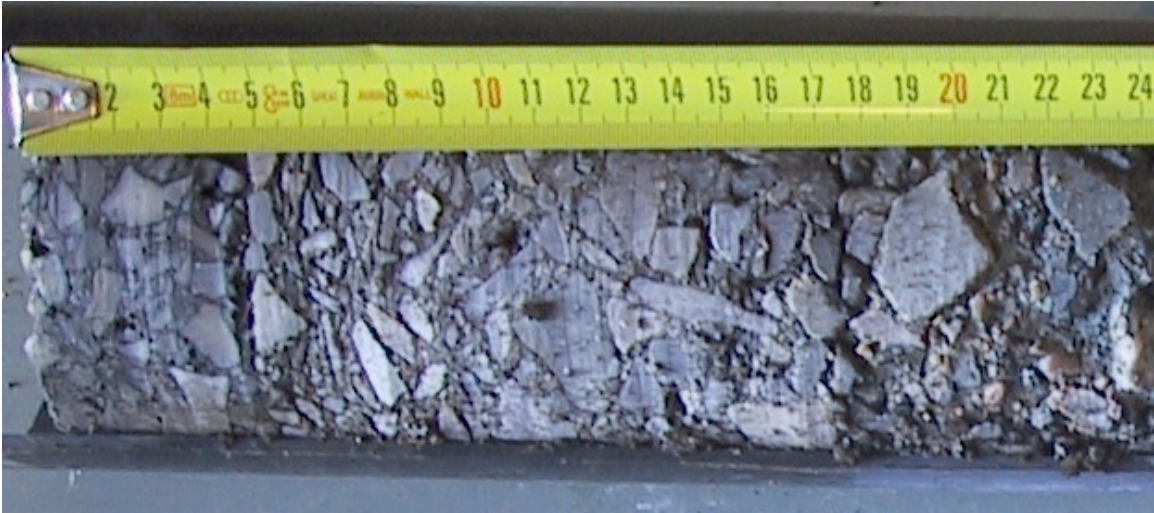
Kuva 22. Poranäytteen yläosa paalulta 19170 suunnalta Kemi - Tornio. Kuvassa näkyy välillä 45 – 95 mm segregatiojään hajoittama ABK:n alaosa ja BST kerroksen yläosa.
