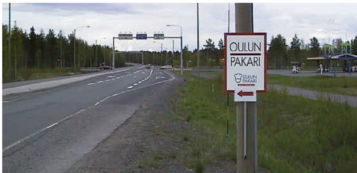
Kuva 18. Valaisinpylvääseen kiinnitetty mainos, joka sekoittaa liittymän virallista opastusta
