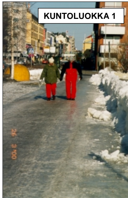
Kuva 56. Hieman epätasainen ja vaarallisen liukas osuus ei tutkimusryhmäläisiltä kehuja kerännyt. Kuntoluokka = 1. Tutkimusryhmäläisten antamien arvosanojen ka = 1,22. Kuntoluokkaa alentavat tekijät: Liukkaus 23/25, epätasaisuus 22/24. (Oulu keskusta 26.03.2000).
