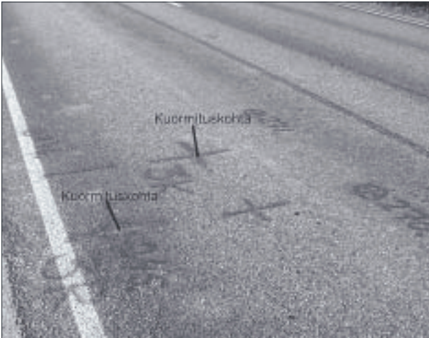
Kuva 35. Alue III kuormituskohdat: numerot esittävät pilarien paikkoja
