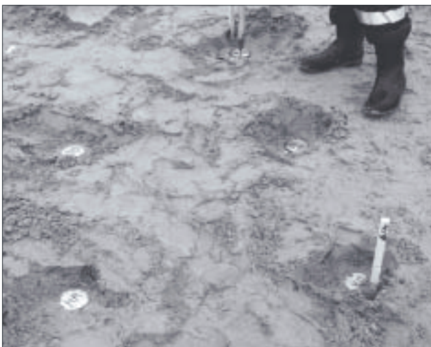
Kuva 23. Maanpainemittareiden sijaintipoikkeamien mittaamista.
