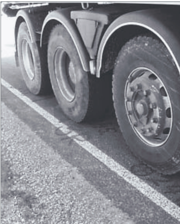
Kuva 36. Keskimmäisen taka-akselin apukuljettajan puoleiset paripyörät ajettiin kunkin kuormituspisteen kohdalle. Kuormittava akseli on varjostettu. Mittaukset tehtiin telipyörät ylhäällä ja alhaalla.
