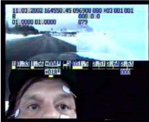
Kuva 18. Koehenkilö talvisella valtatie 7:llä - Instrumentoidun auton mittaus-tulokset myös kuvassa näkyvissä.
