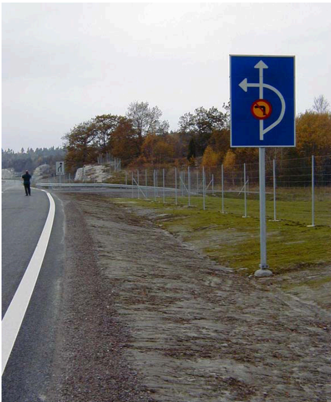
Kuva 2. Päätielle asetettu oikean ajotavan osoittava ja suoraan päätieltä vasemmalle kääntymiskiellosta kertova opastustaulu.
