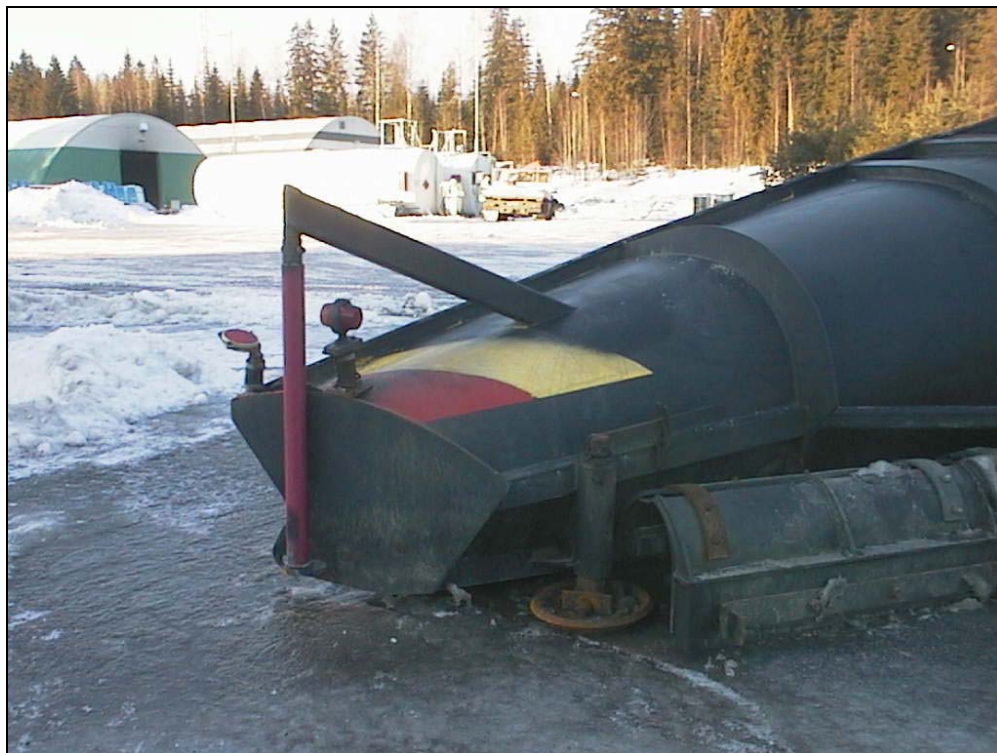
Kuva 3-1 Auraan on lisätty ”sivutela”, jotta keskikaiteen alusta voidaan puhdistaa mahdollisimman läheltä vaurioittamatta kaidetta.
