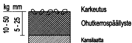
Kuva 15. Betoni-, teräs- tai puukantisen sillan ohutkerospäälyste.
