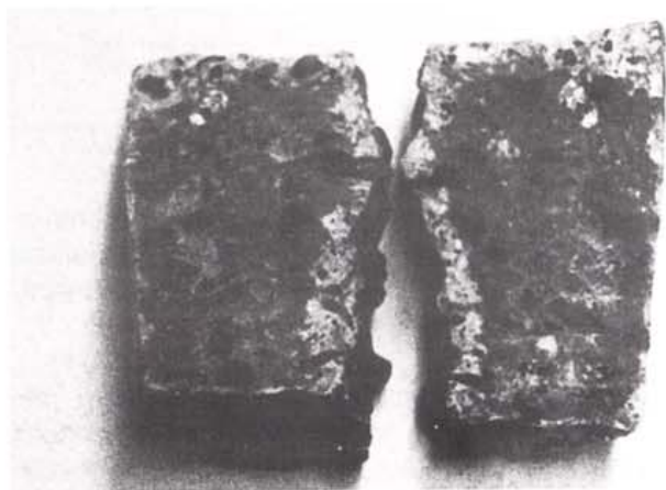
Kuva 31. Karbonatisoitumaton betoni värjäytyy punaiseksi (kuvassa tumma alue), kun pintaan suihkutetaan fenolftaleiinia
