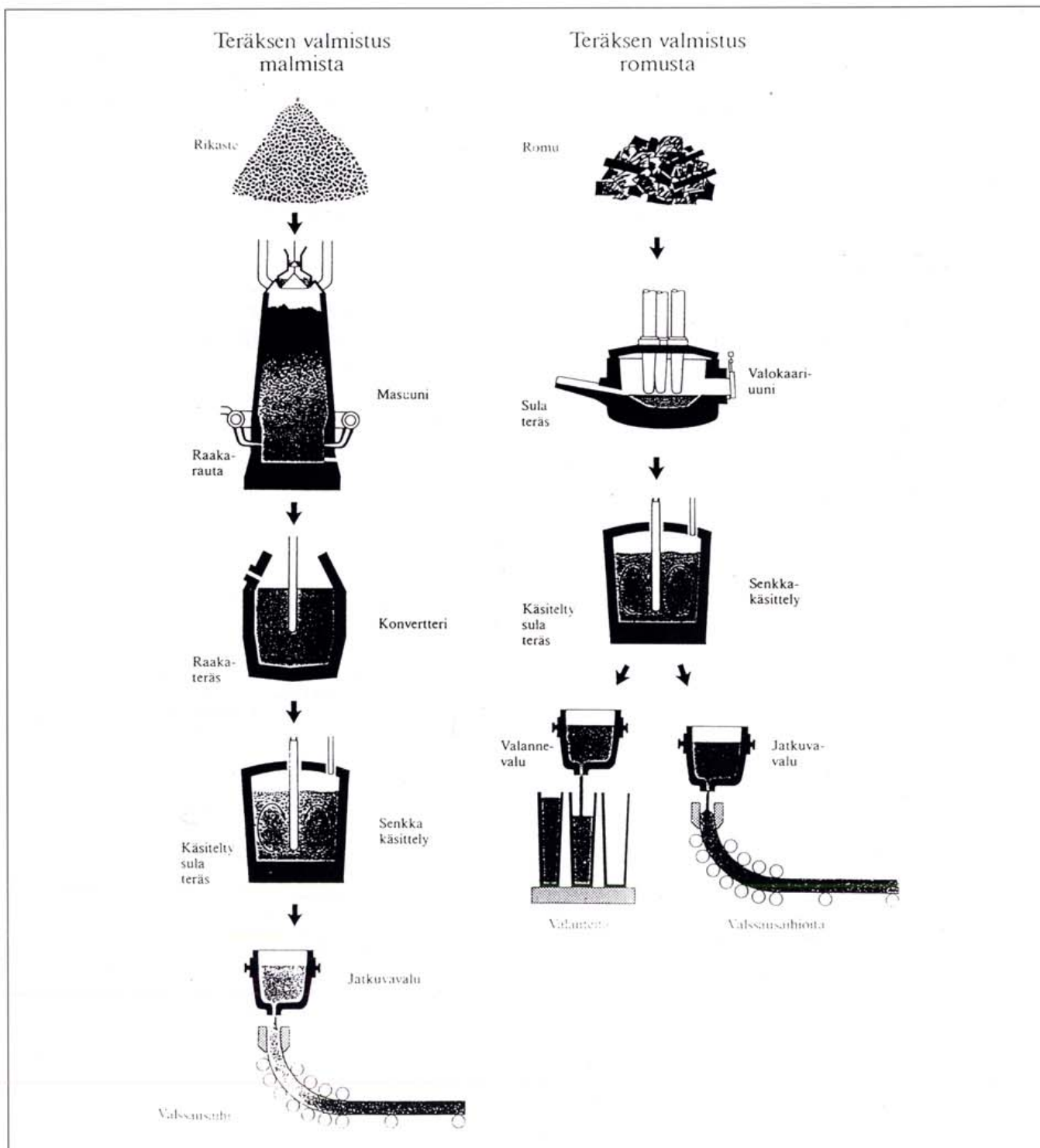
Kuva 18. Teräksen valmistusprosessi (Teräskirja 1983).
