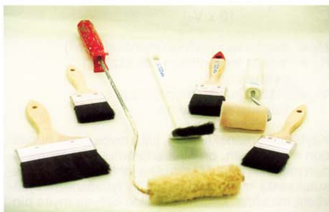
Kuva 46. Siveltimet ja telat, jotka soveltuvat eri maalikerrosten maalaamiseen ja vahvennusmaalaukseen.
