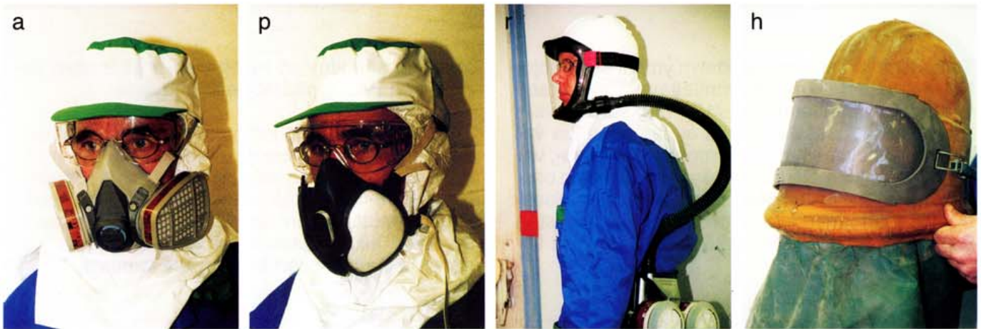
Kuva 55. Aktiivihiihi- ja pölysuodatin (a), pölysuojain (p), raitisilmanaamari (r) ja hiekkapuhaltajan kypärä (h).
