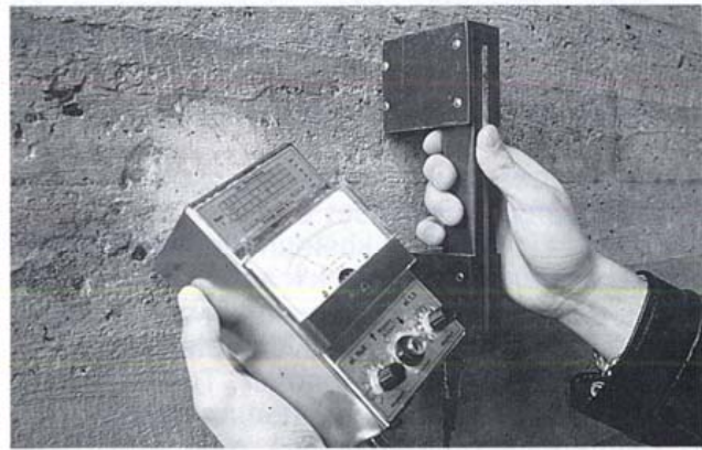
Kuva 5. Raudoitustankojen paikat määritetään.
