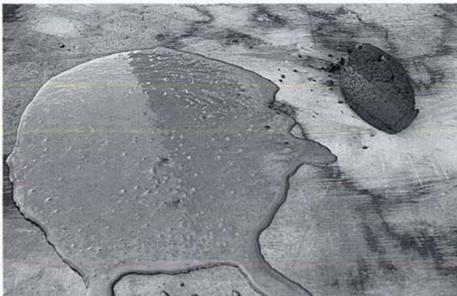
Kuva 3. Notkea juotoslaasti ja valumaton paikkauslaasti.
