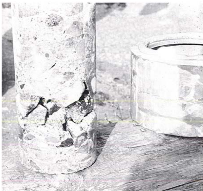
Kuva 2. Poranäytteen paljastama tyhjä tila kansilaatassa.
