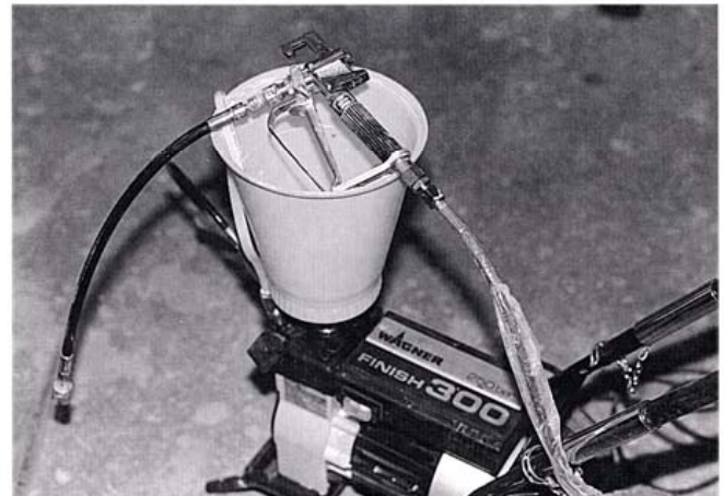
Kuva 13. Konepumppu ja injektointipistooli.
