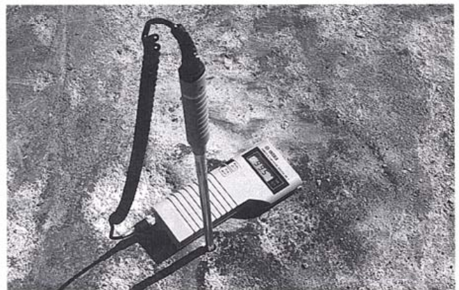
Kuva 16. Betonin suhteellisen kosteuden mittaaminen.
