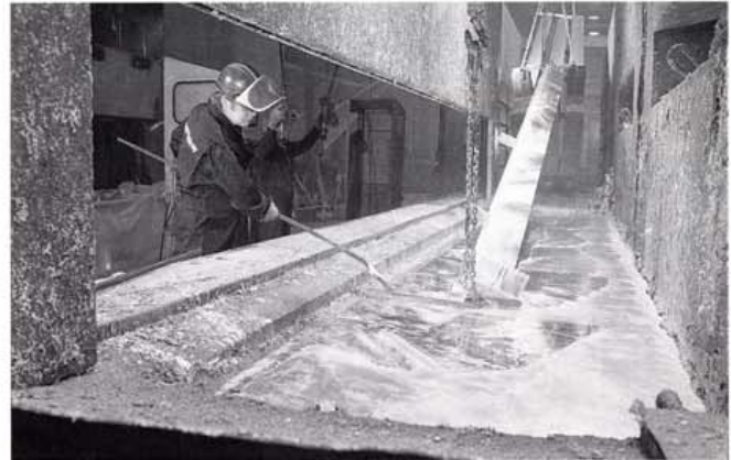
Kuva 9. Kuumasinkityksellä rajoittaa sinkittävän kappaleen kokoa.
