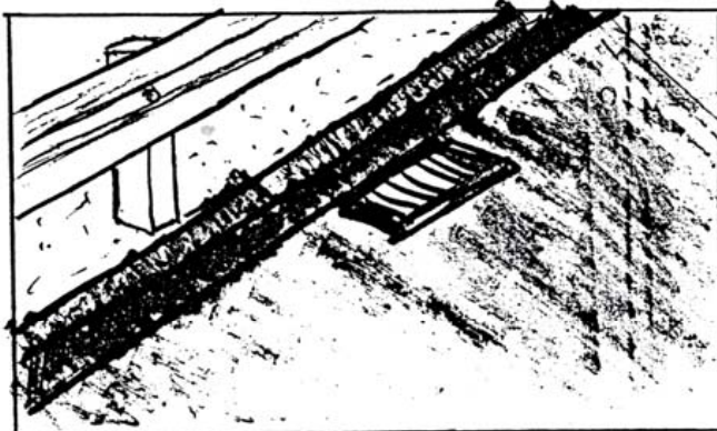
Kuva 11. Asfaltista tehty reunu
