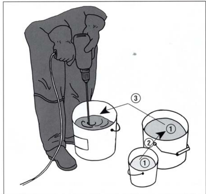
Kuva 13. Eristysmassan komponentit sekoitetaan tuotekohtaisen ohjeen mukaan.
