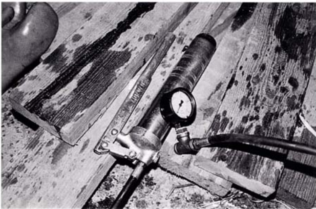
Kuva 1. Yksinkertaisin muovi-injektointilaitte on rasva-puristin.
