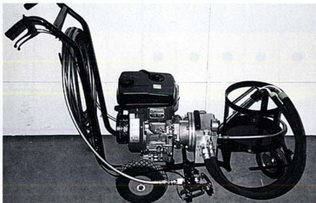
Kuva 3. Polttomoottorikäyttöinen suurpaineruisku ajorata-merkintälaitteella varustettuna.
