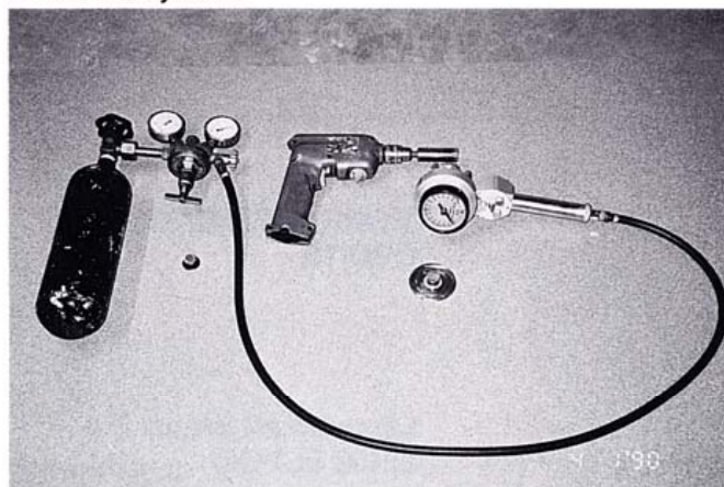
Kuva 2. Vedeneristysten tartuntalujuuden mittauslaitteisto sillalla tehtävää laadunvalvontaa varten.
