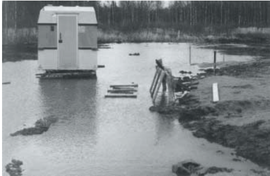
Kuva 5.6 Marraskuun sateiden jälkeen tilanne koekohteella oli lohduton. Mittauskoppi seisoo työmaatien jatkeella, kuvassa oikealla etualalla massastabiloinnin tiivistyspengertä ja massastabiloinnin pintaan asennetut letkupainumamittarit.
