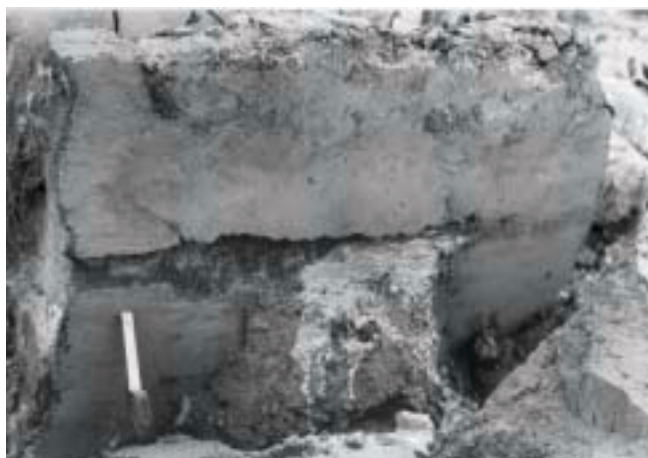
Kuva 3.25 YSe-kentästä nostettu pilarinpala noin syvyysväliä 2–3 m. Selvä läpireikä keskellä, muuten homogeenisen ja lujan näköistä.
