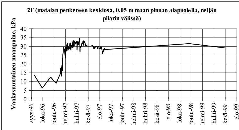
Kuva 6.3 Vaakasuuntaista maapainetta mittaavan anturin 2F tulokset matalan penkereen alla.
