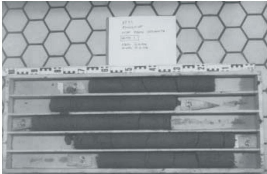
Kuva 5.4 Esimerkki jatkuvasta näytteestä: puoliluja pilari 29, syvyysväli 4,0–6,0 m hiekan pinnasta mitattuna.
