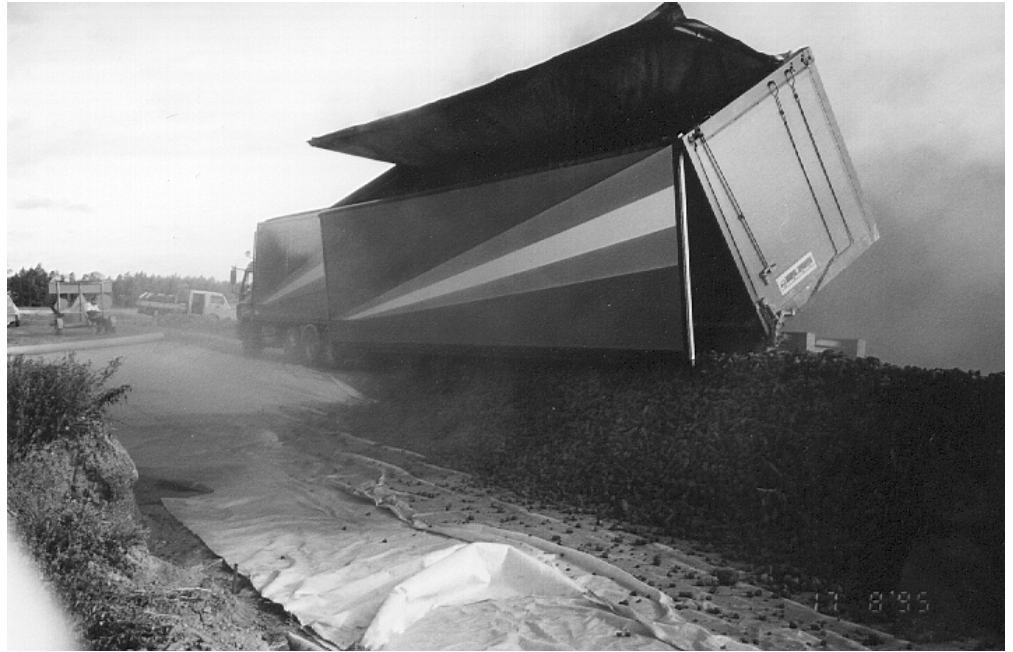
Kuva 8. Palaturpeen toimittamista sivukippiautoilla.
