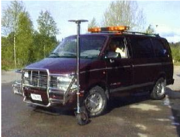
Kuva 1. Tieläiliiketoimen GPS-tiemittausauto yhdellä satelliittivastaanottimella varustettuna.
