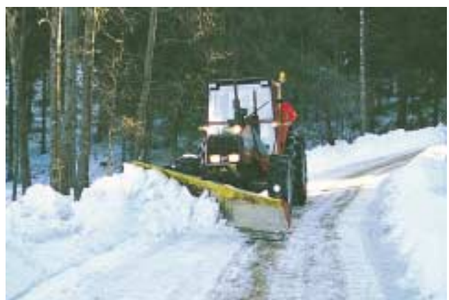
Kuva 33: Auraus on yleensä tehokkain työmenetelmä lumenpoistoon.
